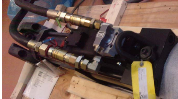
Img. 6.- Actuador de 250kN
